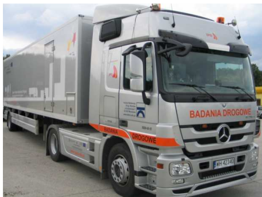
Fot A.1. Przykładowy ugięciomierz laserowy
